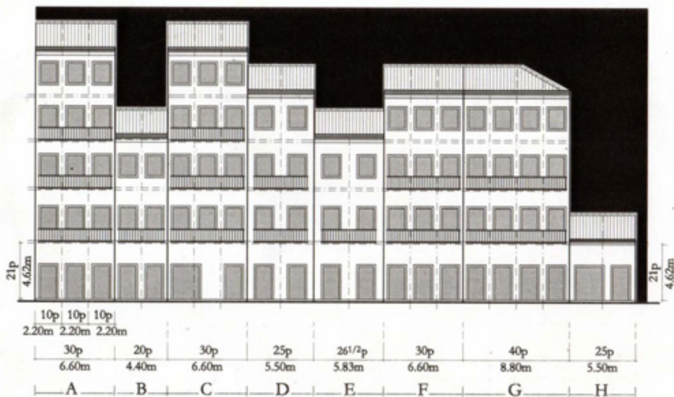
DESENHO 2 – Redesenho das edificações do Cais da Alfândega (1865), segundo a Postura da Câmara Municipal do Recife de 12.10.1839. Elaboração da autora.
