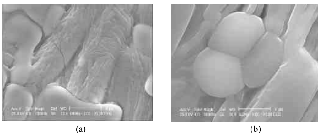
Figura 4.24 – Micrografias obtidas por MEV de superfícies polidas de amostras \text{Ba}_2\text{HoZrO}_{5,5} com 1% de CuO sinterizadas a 1600^\circ\text{C} por 48h através do processo direto. (a) e (b) elétrons secundários.
