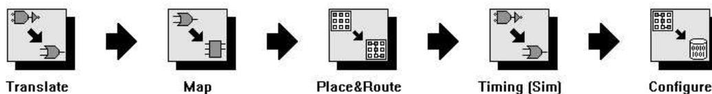
Figura 5.10: Fluxo de implementação das ferramentas Xilinx Foundation Series.
