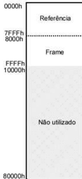
Figura 5.7: Mapeamento de memória utilizado
