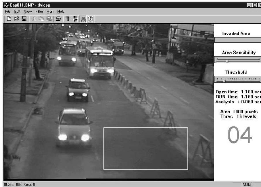
Figura 5.3: Protótipo executável do sistema de detecção de veículos.
