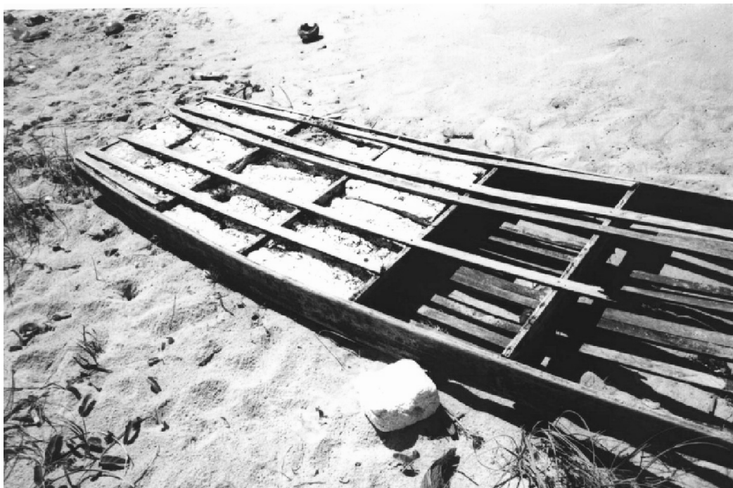
Figura 8: Isopor sendo usado como revestimento de fundo de jangada. Setembro de 2002.
