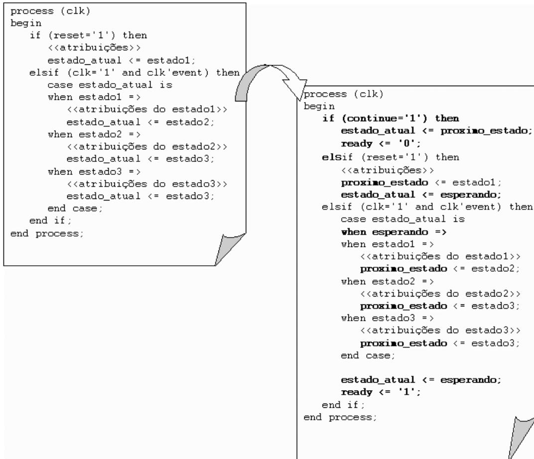
Figura 4.23 – Alterações na máquina de estados do componente
