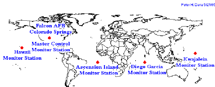
Figura 10: Localização das Cinco Estações de Monitoramento [DAN01].
