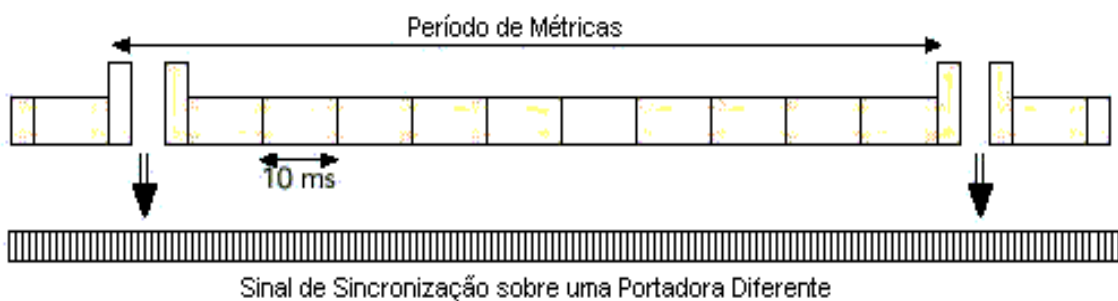
Figura 3.19. Transmissão no Modo Segmentado [DAHL98].
