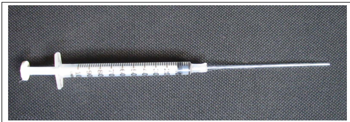
Fig.7. Seringa hipodérmica de 1 mL, adaptada com tubo capilar para aspirar o conteúdo líquido das cubetas
